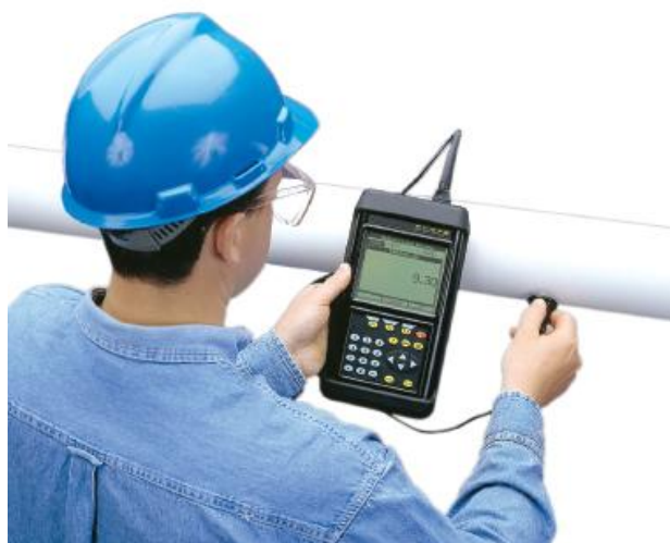
Pomiar grubości ścianek rurociągu
